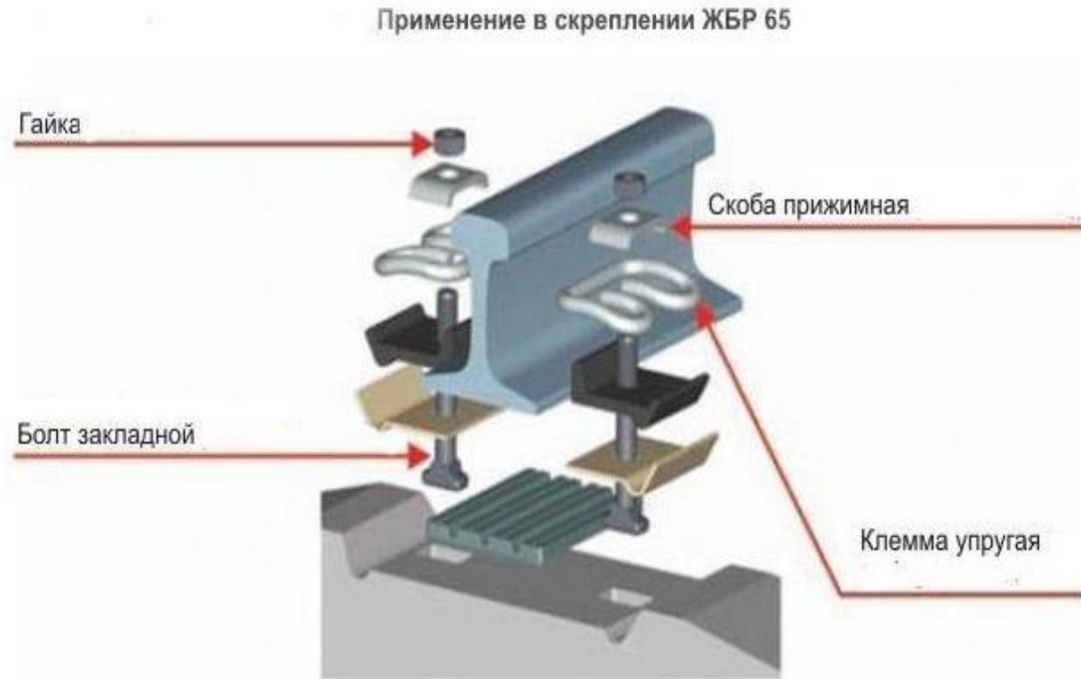
Ш3Нераздельное рельсовое скрепление ЖБР-65
