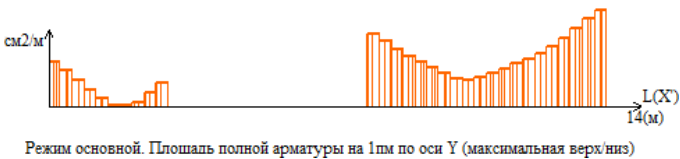
Режим основной. Площадь полной арматуры на 1м по оси Y (максимальная верх/низ)
