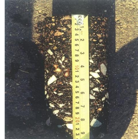
Результаты испытания кернов асфальтоминерального бетонного основания
