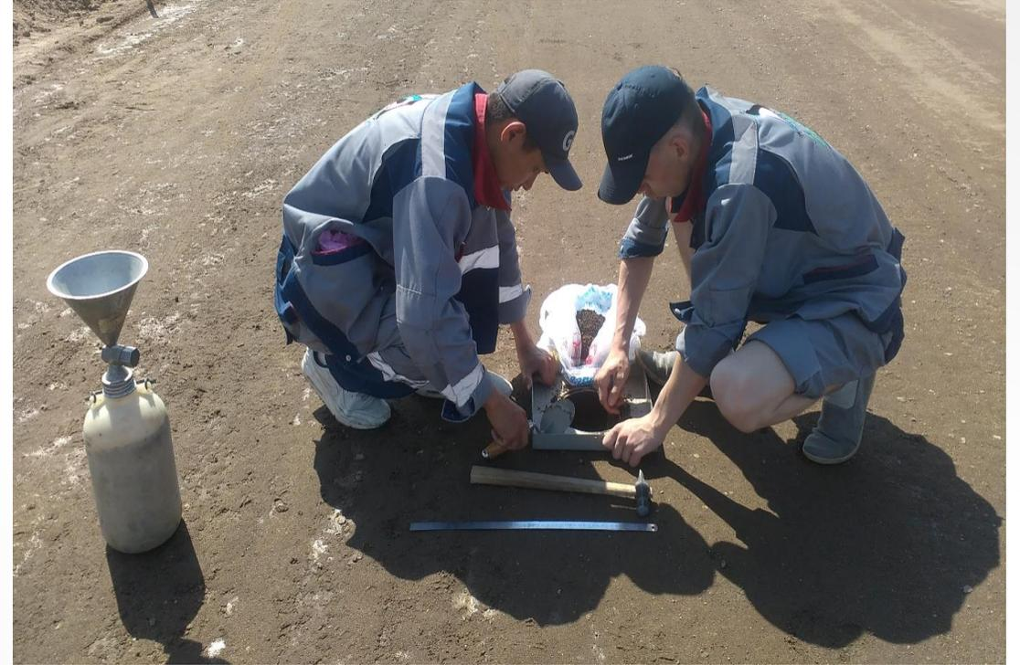
Фото монолитного рабочего слоя земполотна на а/д «Семей-Павлодар»: и контроль качества уплотнения грунтошламобетона до затвердевания
