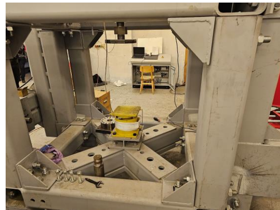
Испытание 3D высоковязкого демпфера ВД по ТУ 4192....
